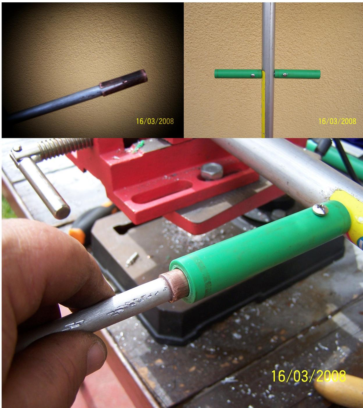
Stessa cosa ho dovuto fare per fissare i due radiatori del dipolo lunghi inizialmente 49 cm. Attenzione nel mentre si esegue questo lavoro, con un tester bisogna constatare che i due dipoli non siano in continuità tra loro e con il resto dell'antenna.
