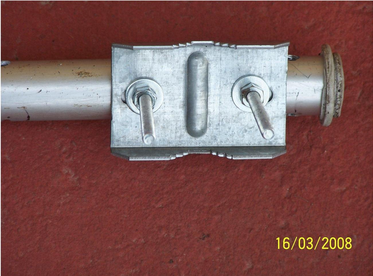
I fori per il fissaggio della suddetta piastra vengono fatti sia per posizionare l'antenna in verticale che in orizzontale anche se io li ho sempre posizionate con gli elementi in verticale al terreno..-
