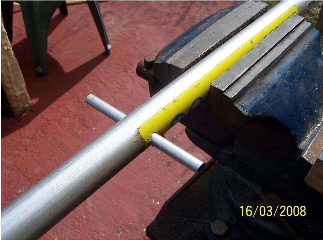
Per realizzare il dipolo che deve essere completamente isolato dal resto dell'antenna, ho prima effettuato lo stesso foro di diametro 9,5 mm come fatto per i direttori, qui ho fissato uno spezzone di tubo lungo 11 cm diametro 9 (vedasi figura);
