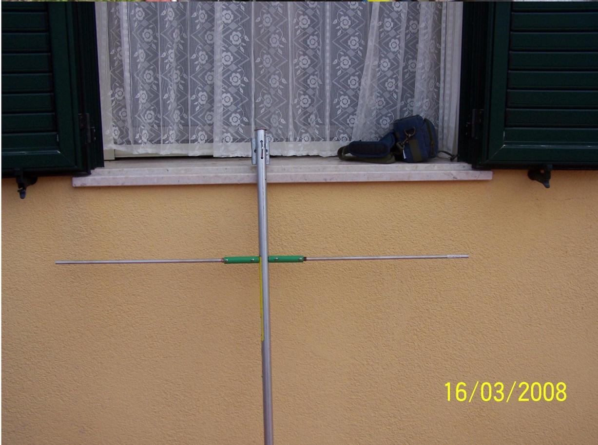
Si passa alla realizzazione del riflettore che deve essere lungo 151 cm formato da un tubo in alluminio di diametro 10mm lungo 100 cm e due spezzoni di altro tubo di diametro 8 mm che arrivano alla misura totale. L'ultima parte del tubo boom che e circa 16 cm serve per fare i fori per mettere la piastra di fissaggio antenna (piastra per fissaggio antenne TV).
