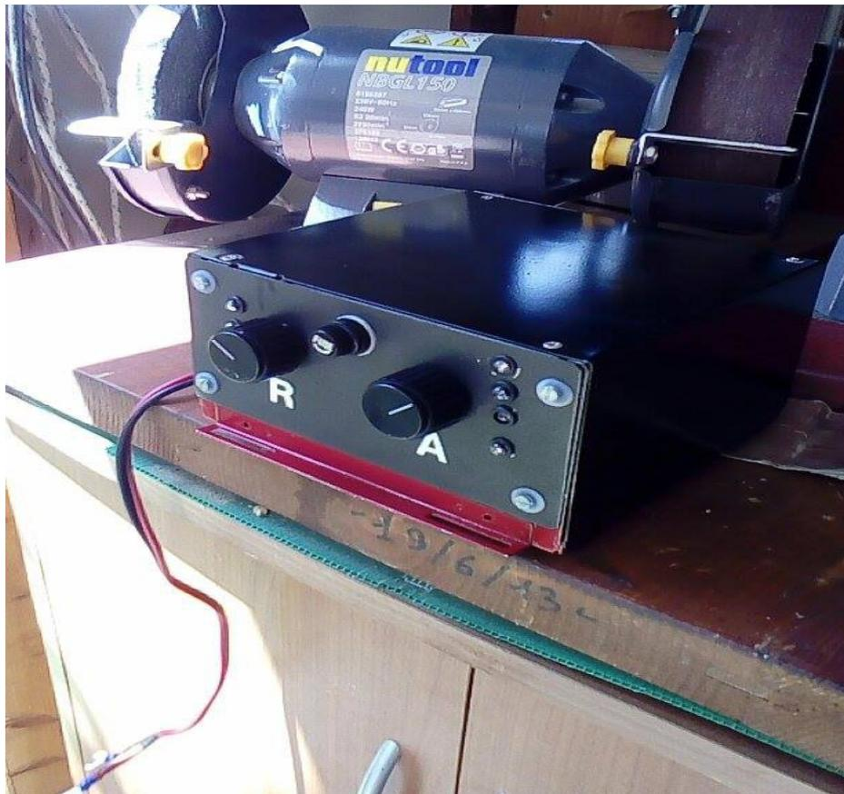
Il tutto viene pilotato a 12 volt, mediante dei commutatori a più posizione che hanno il compito di alternare corrente uno al relè antenne e uno al relè rtx. Ho usato anche dei led a 12 volt che indicheranno quale rtx o antenna si sta usando, per sicurezza ho messo un fusibile.
