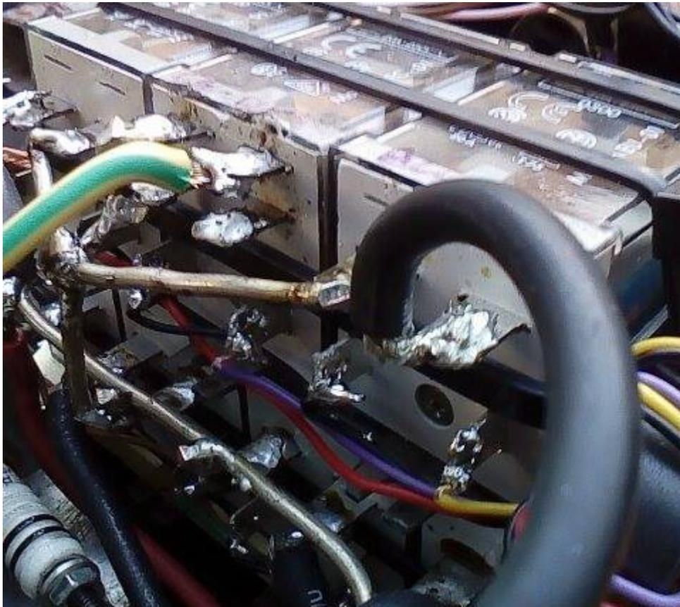
Alla fine cercate di schermare la parte dei collegamenti alle antenne con un piccolo coperchio in alluminio. E tenete conto che questi selettori, misurandoli con strumento, mantengono un ros accettabile e impedenza idonea ai 50 ohm nelle bande HF basse, dai 14 mhz in su la cosa cambia...che va riportata quasi alla normalità, agendo su tratti di collegamenti antenne e rtx, da farsi il più corte possibile.....mettendo ad una buona massa lo scassy dei poli freddi, scintillatore ecc ecc.
